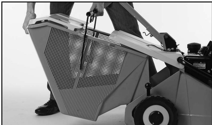
Debe levantarla sólo para colocar el recogedor. En ningún caso debe desmontarse.
