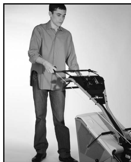
Coloque o manipulo de comando dos gases directamente sobre a posição MAXI e arranque o motor.
